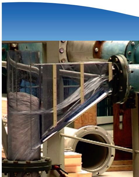
Figure 1 : Vue de la tête génératrice de Vortex sur le banc d'essai du CERG
