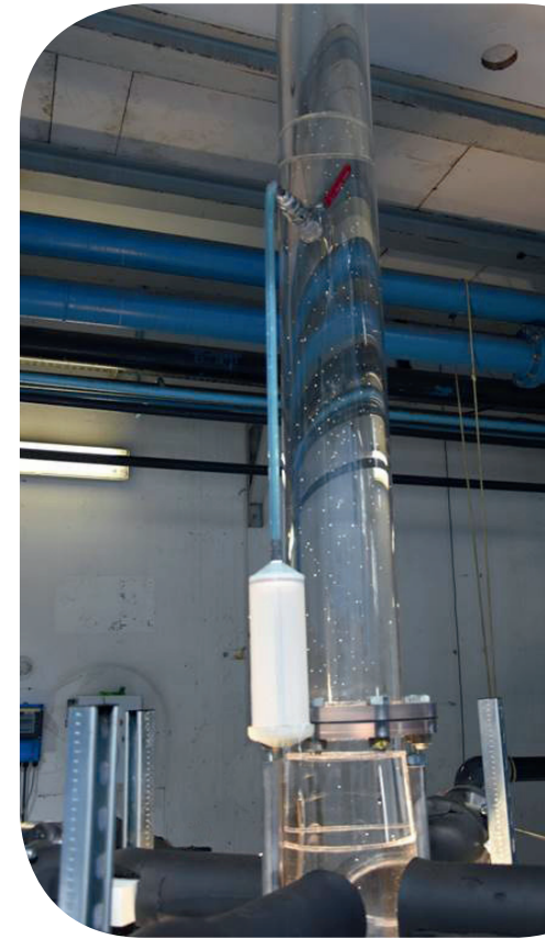
Figure 2 : La boucle d'essai avec son injecteur sans son calorifuge
