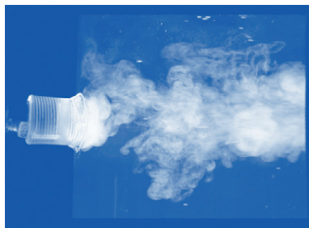
Figure 3 : Injection des débris avec une vitesse ascendante de 2mm/s
