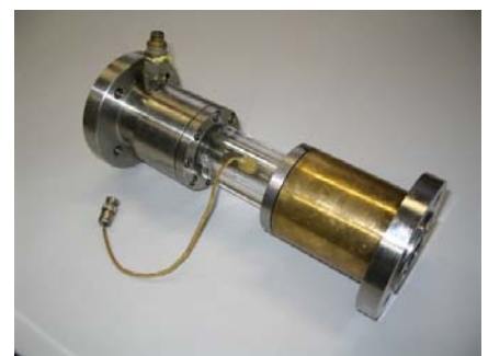
▲ Vue du Venturi
