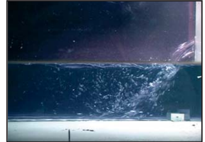
▲ Écoulement à la rupture du radier
